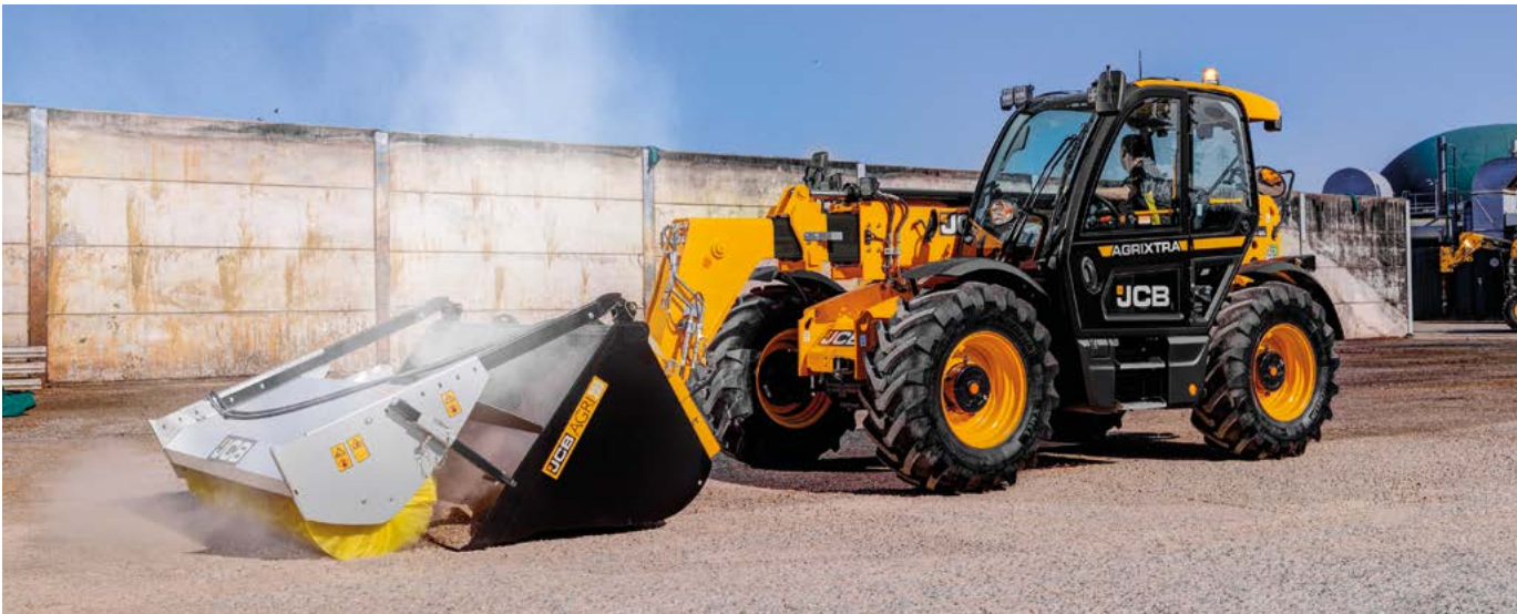
Schaufeln sind ab Werk mit Montagehalterungen für die jeweilige Kehrmachine ausgestattet.
